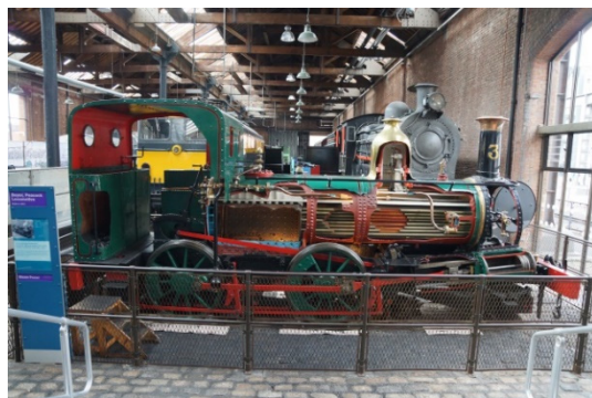
火車整個側面解剖示意
