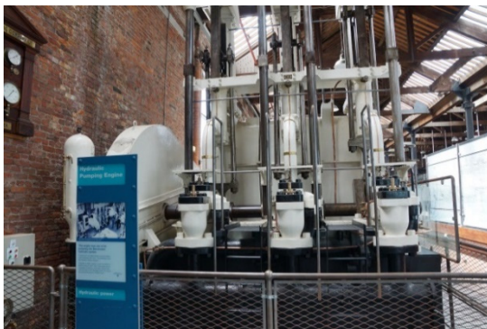
液壓幫浦，此引擎原為蒸汽動力，後於 1927 年改為電力。
