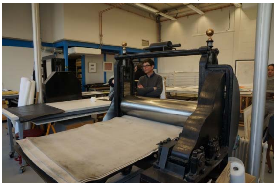
鋪上布毯，先在待印紙上施壓，準備開始印刷
