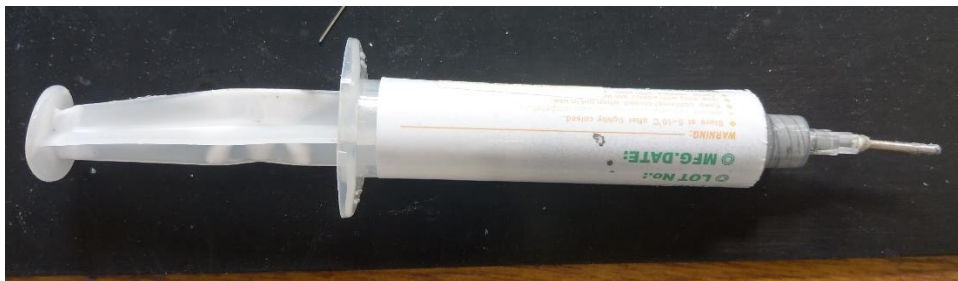
圖 4.1.3 錫膏(搭配熱風槍使用)
