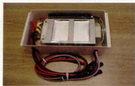
日本Zephyr公司 之小型風力發電設備 及所使用的超電容模組
